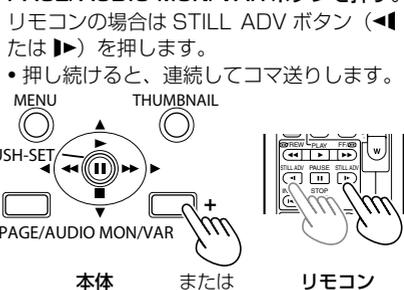
通常の再生に戻すには、OPERATION レバーを▶（再生）方向に倒します。
