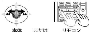
通常の再生に戻すには、OPERATION レバーを▶（再生）方向に倒します。
