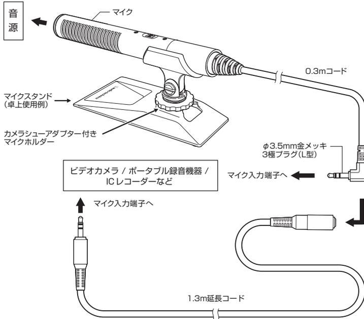
\* ステレオ入力端子に接続して録音した場合は左右から同じ音が再生されます。
