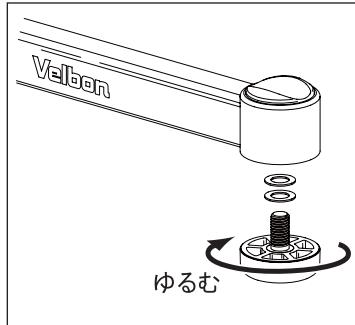
最初から取り付けてある、平ベースを回して外します。このとき2枚のワッシャーが落ちて無くならないよう御注意下さい。
