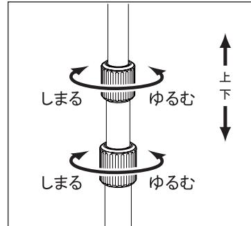
ロックナットを回してメインポールを上下させます。必要な高さになったら、ロックナットを反対に回してしっかりと固定します。
