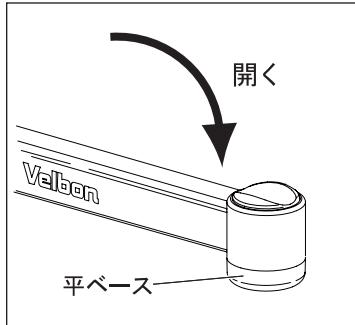
アーム(脚)を完全に開き、床や地面に確実に接地させます。3つのアーム(脚)を開いてください。
