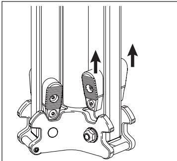
開脚ツマミを上図矢印方向へ持ち上げながら、アーム(脚)をゆっくりと開いていきます。
