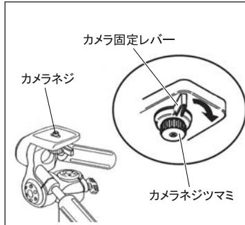
カメラ底部のネジ穴にカメラネジを合わせ、カメラネジツマミをしっかりと回して締め付け、最後にカメラ固定レバーを矢印方向にロックして固定します。
