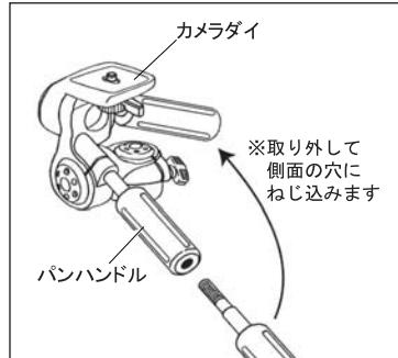
パンハンドルのグリップに、サイドティルトハンドルがさし込まれていますので、サイドティルトハンドルを外してカメラダイ側面に取り付けをご使用ください。
