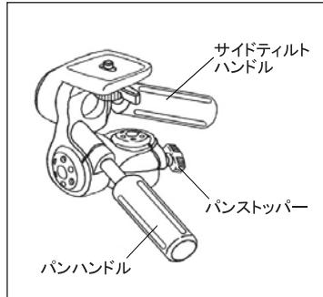
パンハンドルを反時計方向に回してゆるめると、カメラの上下方向が変えられます。サイドティルトハンドルをゆるめると、カメラを縦位置にできます。パンストッパーをゆるめると、カメラを水平に回転することができます。フレームが決まった位置で各ストッパーを確実にしめ、シャッターをきります。
