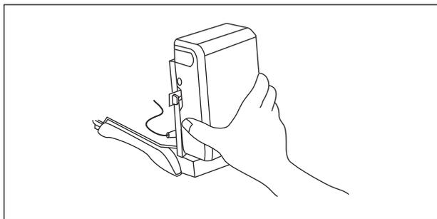
7. ST-7S300 電源スイッチをONすると、LEDが点灯(緑色)し、カメラ等に電源を供給できます。
