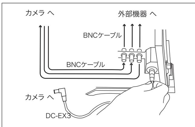
5. カメラからのBNCケーブルをBNC-BNCコネクタで中継できます。
