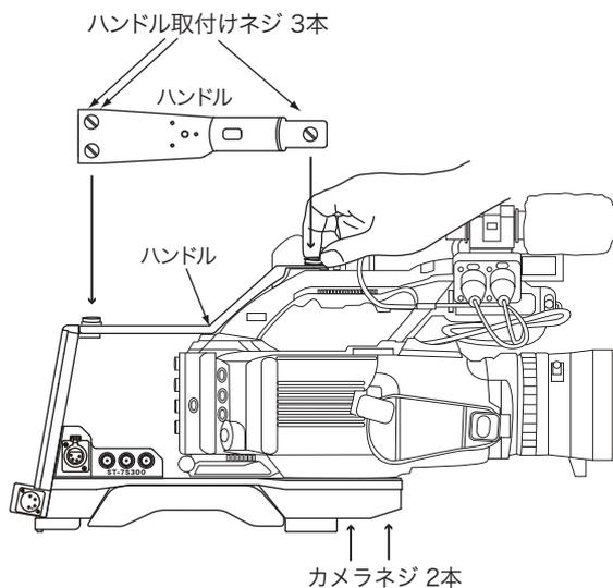
3. 5本のネジ、ネジ穴がうまく合うように、カメラの位置を合わせた後、ネジを締めて固定します。
