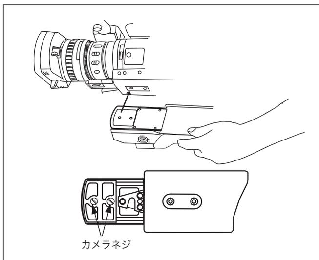
2. ST-7S300のハンドルをPMW-300の取手上部のネジ穴に合わせて3本のネジにて取付けます。
